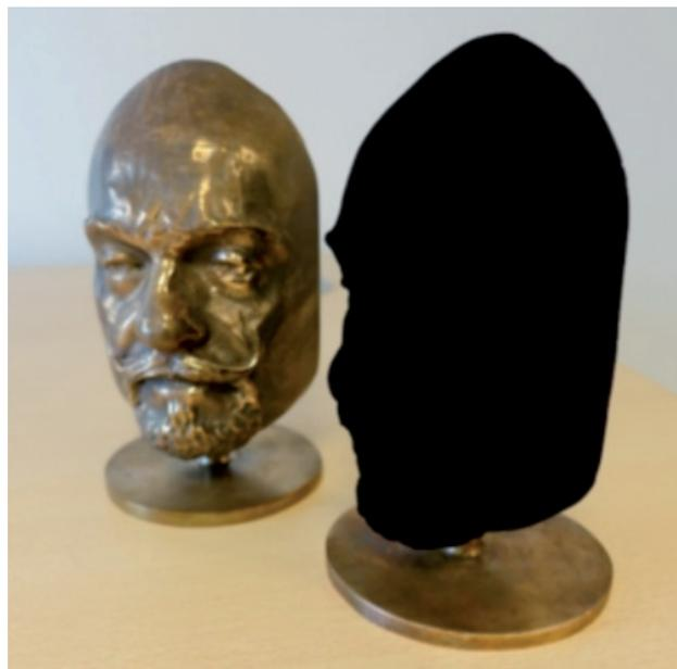
8 Máscara metálica vs. la misma máscara cubierta con Vantablack.
