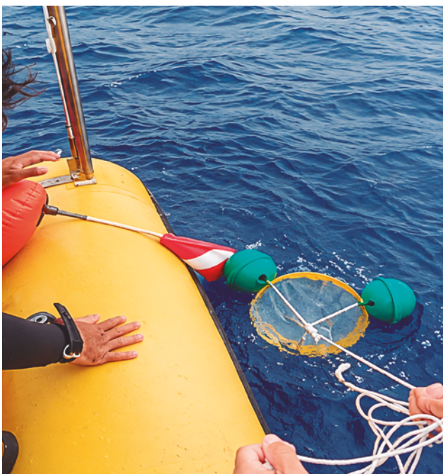
Muestreo superficial por arrastre a velocidad constante
