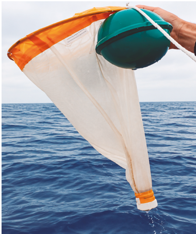
Detalle malla de plancton (tamaño de poro 80 \mu m) con flotador utilizada en el muestreo superficial de agua de mar
