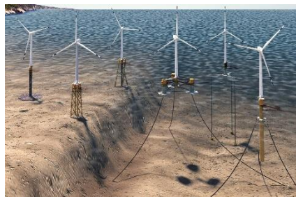
Figura 1 – Tecnología eólica offshore
