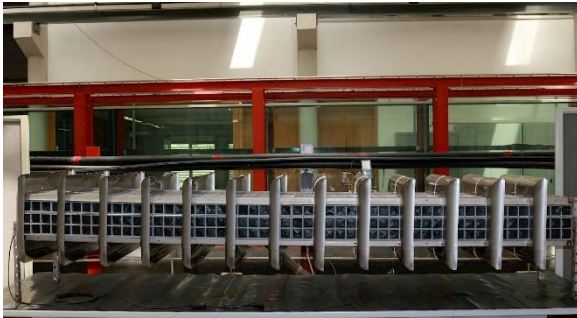
Dispositivo innovador que convierte la energía almacenada en las olas del mar en energía eléctrica
