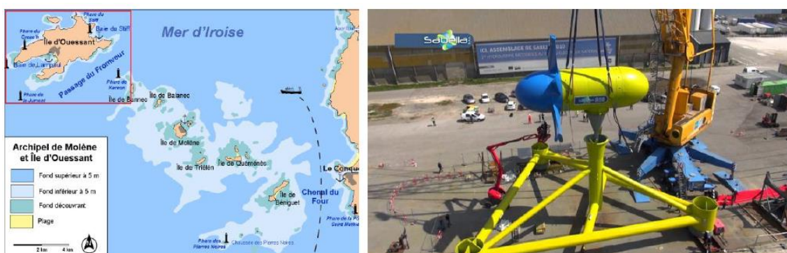
Figura 4. El dispositivo D10 de la compañía francesa Sabella SA se está probando en el estrecho de Fromveur en la isla Ouessant, frente a la costa de Bretaña (Francia), uno de los sitios más energéticos de Francia con velocidades actuales superiores a 3.8 ms -1 . La isla de Ouessant aspira a ser una comunidad de energía sostenible con el uso de energía solar, mareas y viento.
