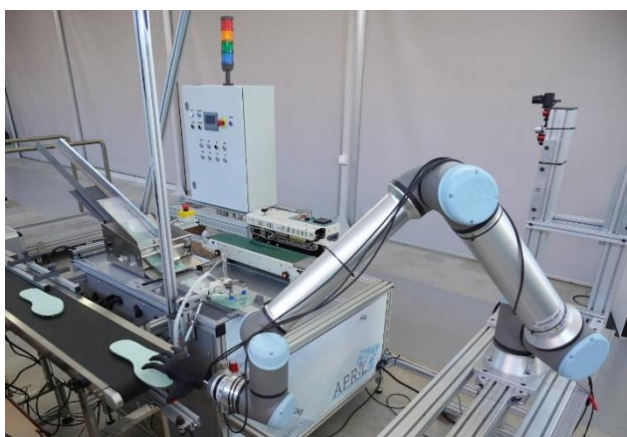
Celda robótica de embolsado de plantillas desarrollada por INESCOP
